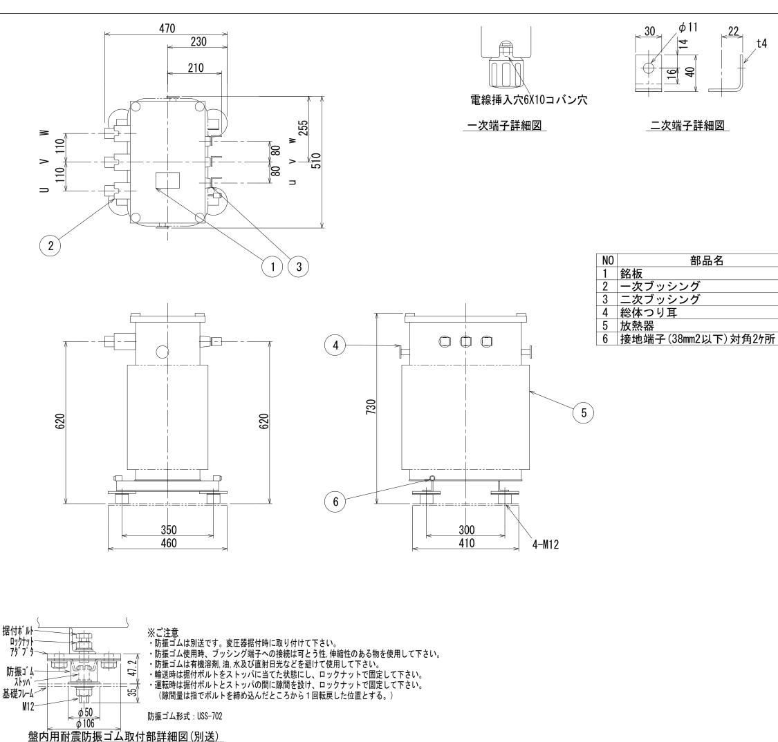
特記事項 形式 T2SP-PW2 標準番号 T2SP-30P-W2 適用規格 JIS C 4304:2013 トップランナー変圧器 2 O 1 4 出荷時タップ 6600V 油面位置はケース内一次側に赤色にて 表示しております。 定格銘板の予備1枚/台を付属(シール) 耐震強度 水平震度 1G 鉛直震度 0.5G
