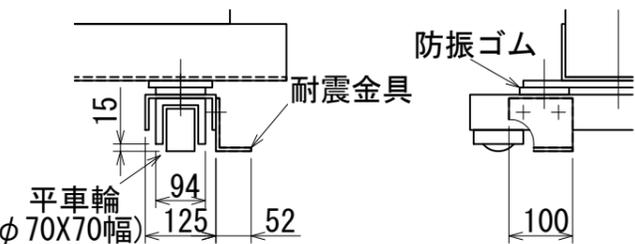
耐震構造防振ゴム平車輪詳細図
