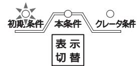
2. 「クレータ」キーを押し、「有」または「反復」のLEDを点灯させます。
