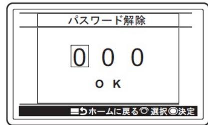
2. 操作BOXの画面調整つまみを回し、入力する桁を選択し、つまみを押します。
