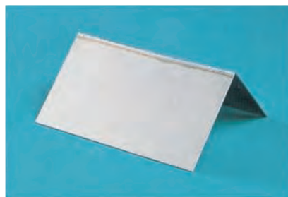
ステンレス0.3mmのカド溶接
