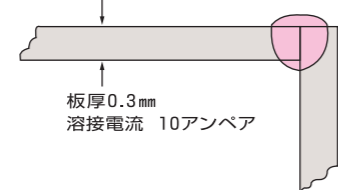
ステンレス0.3mmのカド溶接
