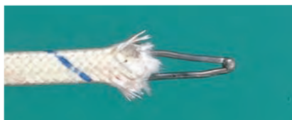
熱電対の溶接(線径0.25mm) 溶接電流 1アンペア
