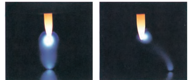
「マイクロティグ」(高周波パルス重畳) アークの集中が良い(溶接電流1アンペア) 従来のアーク アークがふらつく(溶接電流1アンペア)
