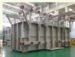
塗装乾燥中の 変圧器ケース
