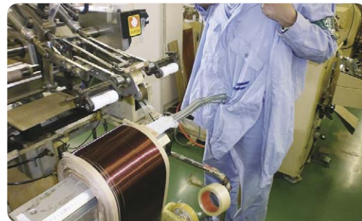
巻線機で作業着の巻き込まれの体感風景
