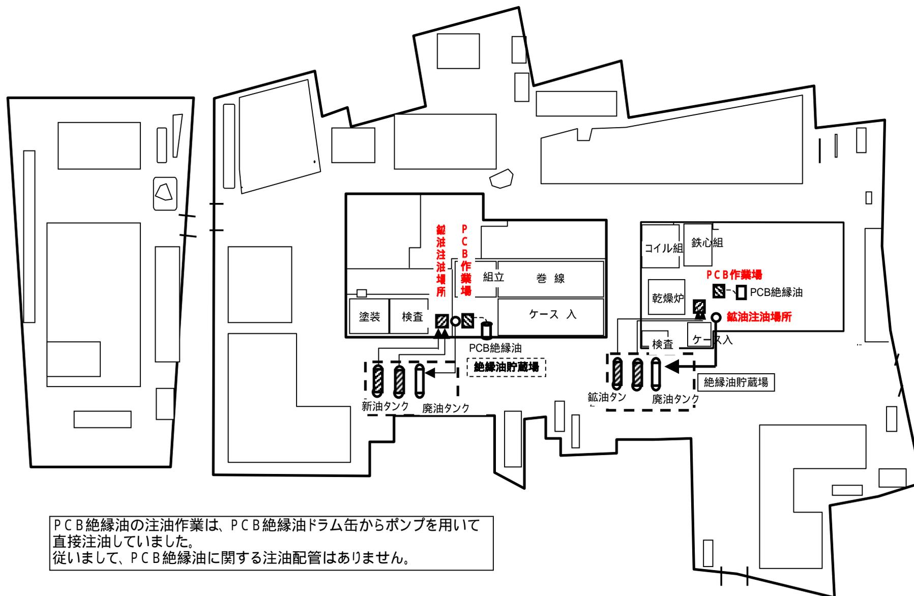
PCB絶縁油の注油作業は、PCB絶縁油ドラム缶からポンプを用いて直接注油していました。
